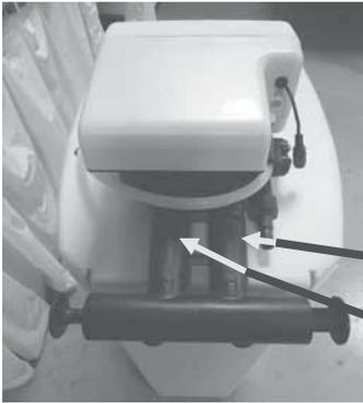
Den Bypass an der Rückseite des Kopfes positionieren.
